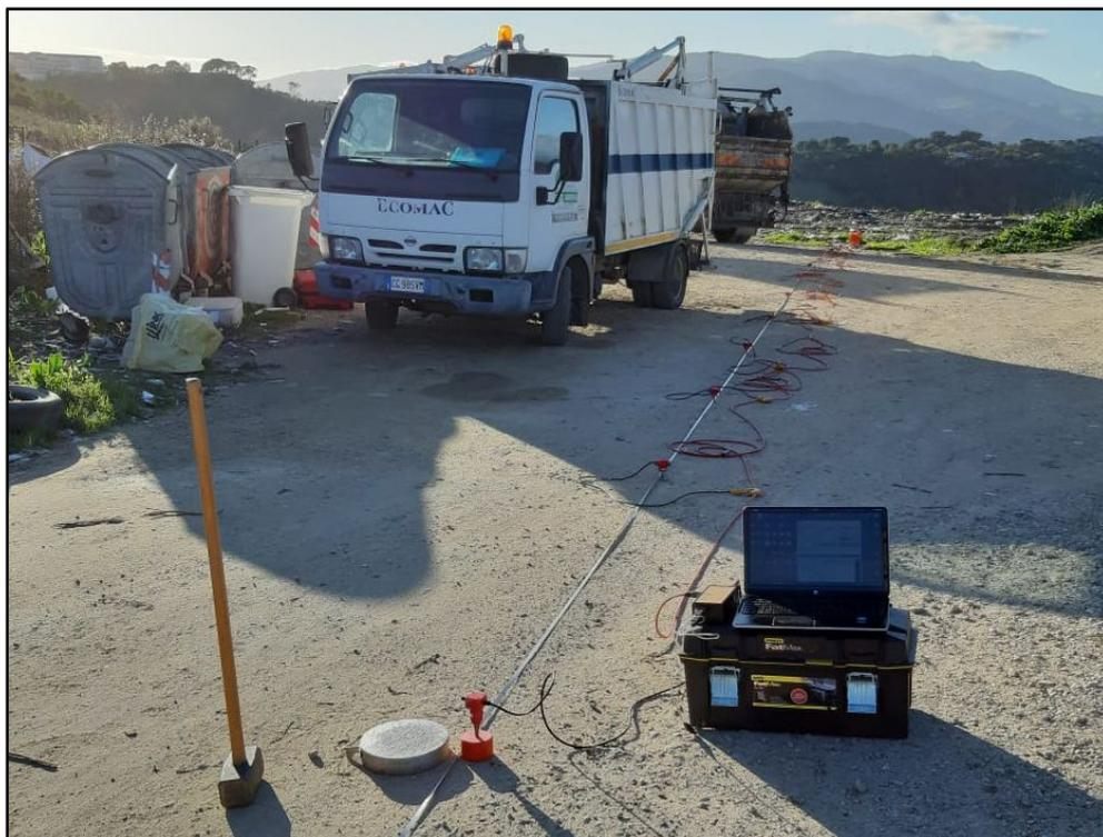
La prova MASW (*Multichannel Analysis of Surface Wave*) è un'indagine di superficie, non invasiva, che non risente di eventuali inversioni di velocità con la profondità e che consente di determinare l'andamento della velocità delle onde di taglio (*Onde S*) nel sottosuolo mediante l'analisi della dispersione delle onde superficiali o Onde di Rayleigh nel dominio del tempo.
