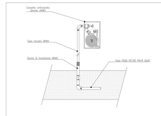
Dettaglio costruttivo collegamento idrante alla rete di distribuzione - Scala 1:20
