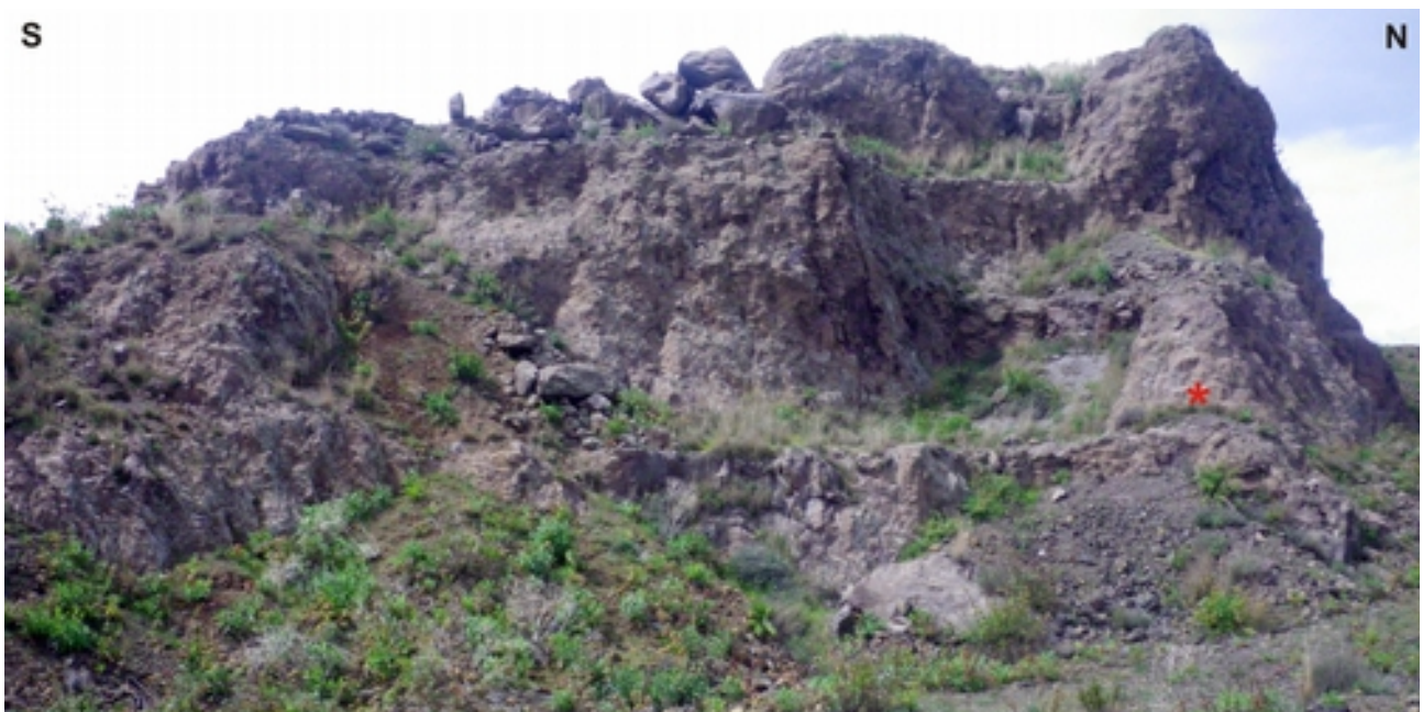
SOI-29bis. L'asterisco indica la discontinuità sulla quale sono state eseguite le misure con lo sclerometro.
