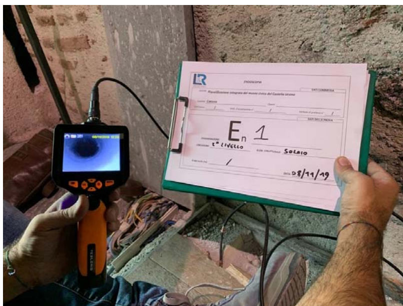
Foto n° 5 – Videoendoscopia Solaio - 2° Livello quota +6.10 m
