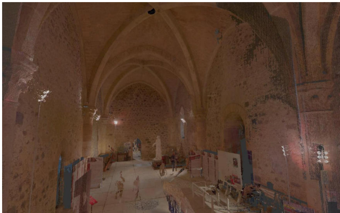
Ricostruzione del modello 3d e rilievo interno tramite laser scanner – salone di ingresso
