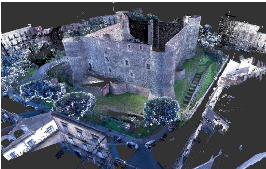
Ricostruzione del modello 3d e rilievo esterno tramite laser scanner – vista lato sud - est
