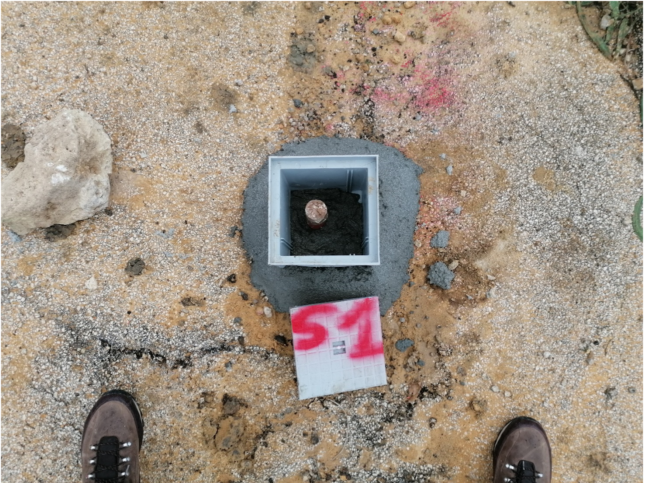
Piezometro nel sondaggio S1
