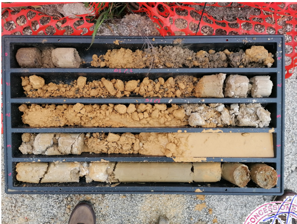
Sondaggio 1 cassetta 1 da 0 a 5 m
