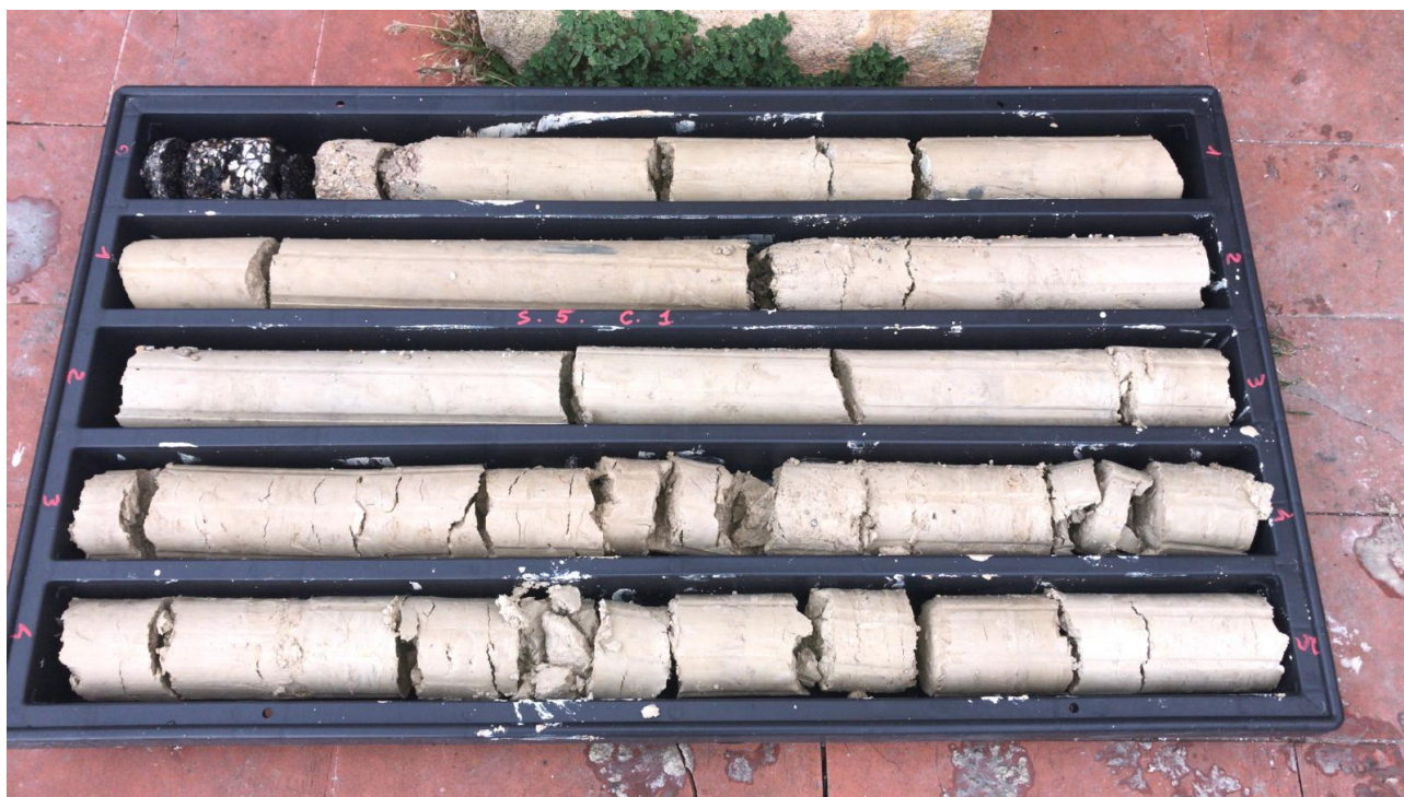
Sondaggio 5 cassetta 1 da 0 a 5 m
