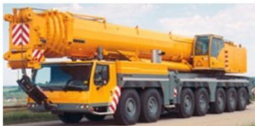
L'autogru è un automezzo pesante in grado di provvedere alla movimentazione di materiali in località dove non è disponibile una installazione fissa. Spesso, quando montata su autocarri provvisti di cassone, con un unico mezzo di trasporto si è in grado anche di trasferire le merci movimentate e non si chiama più autogru, ma diventa un allestimento come da norma UNI EN 12999:2003 dove si legge:
