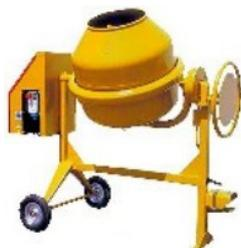
Attrezzatura utilizzata per la preparazione di malta o calcestruzzo. Se posta in aree a rischio di caduta dall'alto, essa dovrà essere protetta con idonea tettoia o del tipo integrata con protezione metallica.
