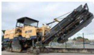
La fresa scarificatrice è un veicolo semovente atto alla rimozione della pavimentazione stradale.
