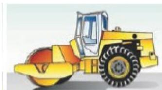
Il rullo compressore è un mezzo operatore utilizzato per il compattamento del terreno e/o dei materiali utilizzati per la formazione del corpo stradale, al fine di uniformarlo e renderlo perfettamente aderente allo strato sottostante.
