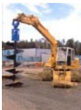
La trivellatrice è una macchina utilizzata per perforare (trivellare) del materiale solido (o semi-solido) per mezzo di un'elicoide che ruota sul suo asse ed in questo modo estrae il materiale creando una perforazione nel corpo in questione.
