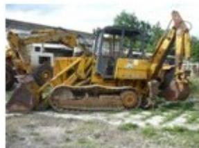
Macchina semovente a ruote o a cingoli, costituita da una struttura di base progettata per il montaggio sia di un caricatore anteriore che di un escavatore posteriore.
