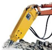
Automezzo utilizzato per la demolizione di opere in calcestruzzo, massicciate stradali ed altro.
