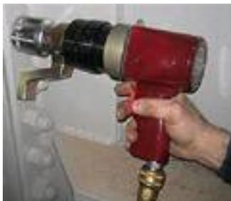
Un avvitatore è uno strumento atto ad avvitare le viti. Si tratta della versione
