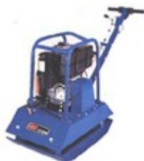
Attrezzatura utilizzata per la compattazione di materiale di diversa natura.
