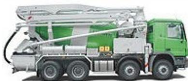
L'autobetoniera è un autocarro su cui è stata installata una betoniera (macchina per l'edilizia avente la funzione di impastare e miscelare tra di loro i componenti della malta o del calcestruzzo).
