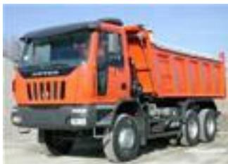
Mezzo di trasporto utilizzato per il carico e scarico di attrezzature, materie prime, materiali edili, materiale di risulta delle lavorazioni, ecc.
