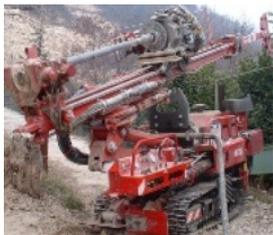
Utensile specialistico utilizzato per forare il calcestruzzo, anche armato, e rocce, in assenza di percussione, con corone diamantate ad acqua.
