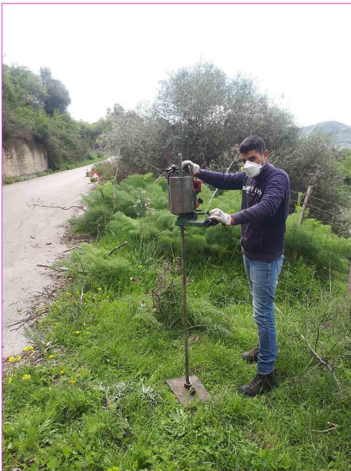
Foto n° 15 ESECUZIONE PROVA SPT10
