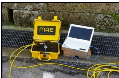
Figura 15: Sismografo M.A.E. Sysmatrack
