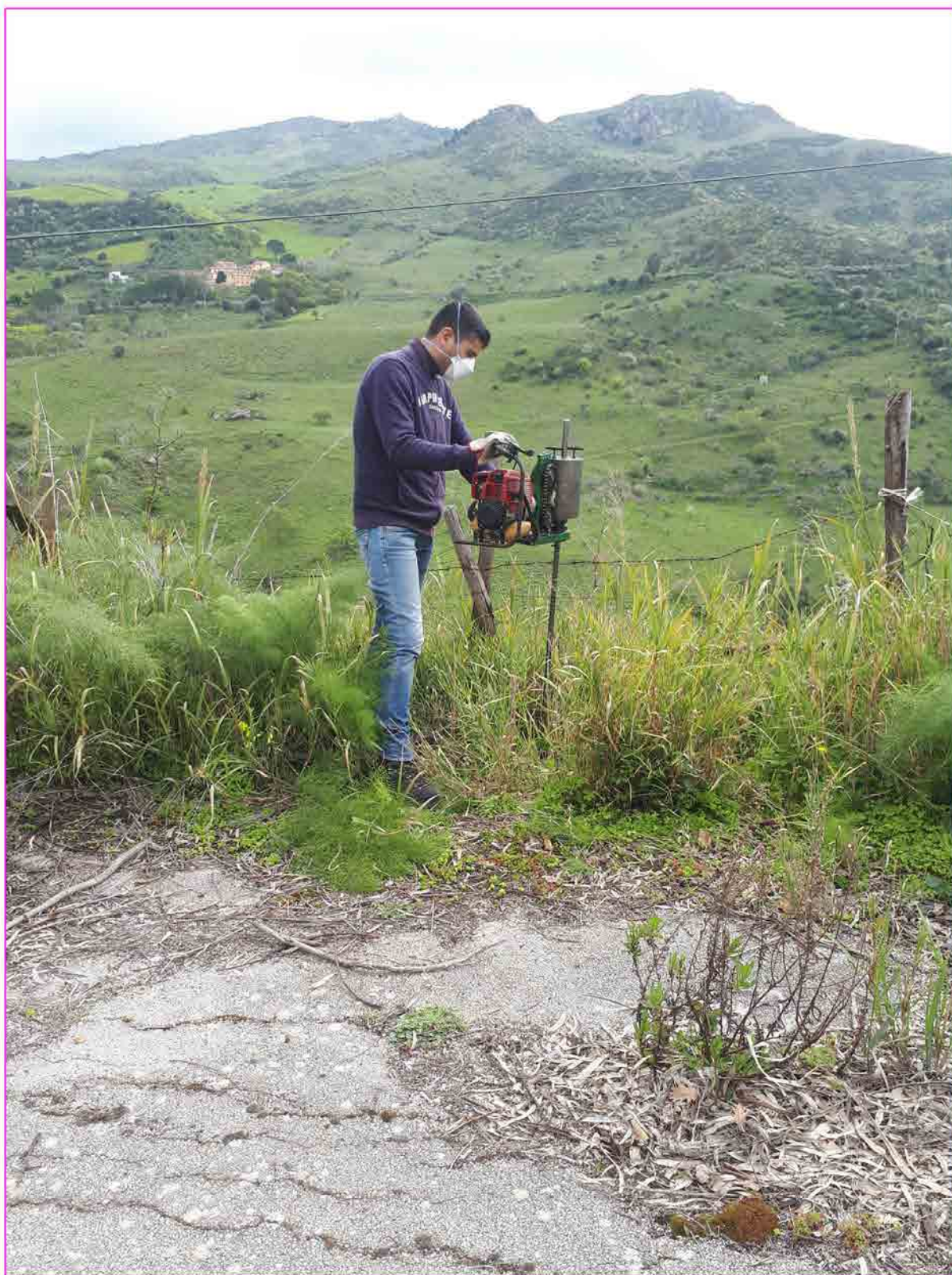
Foto n° 16 ESECUZIONE PROVA SPT11
