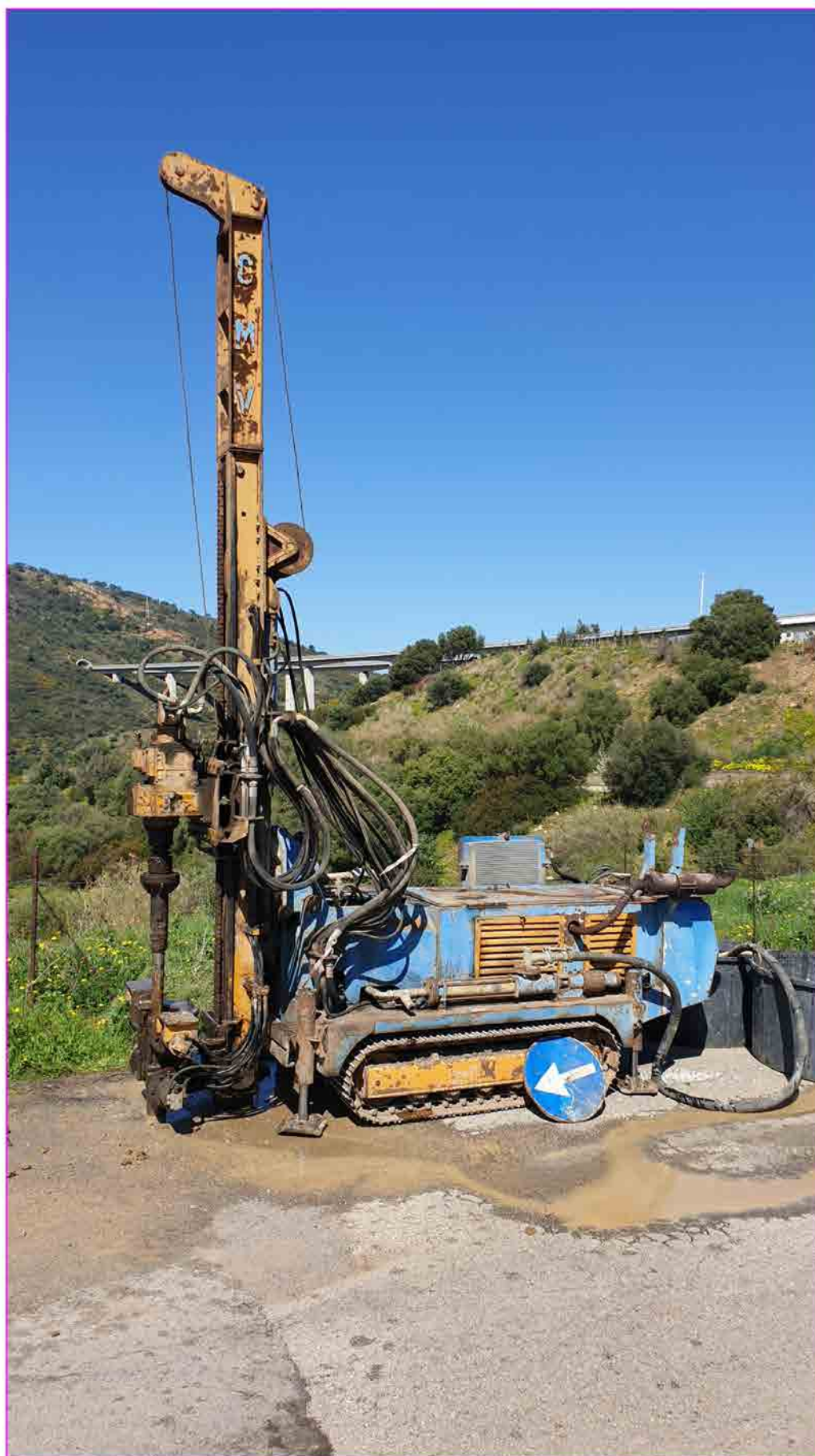
Foto n° 17 ESECUZIONE CAROTAGGIO GEOGNOSTICO C3
