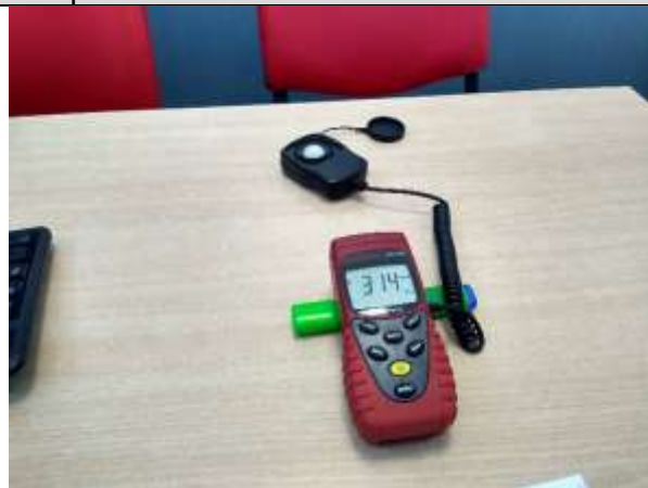
Misure illuminotecniche sul piano di lavoro in stanze tipo Ufficio
