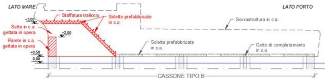
FASE 2: Elevazione delle pareti e dei setti in c.a. della prima fila di celle lato mare;
