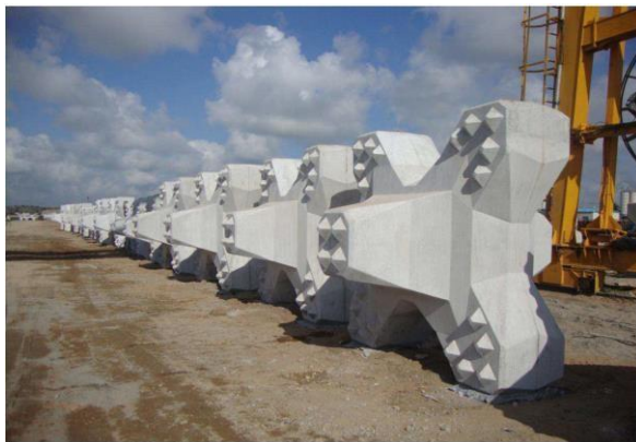
Esempio di massi in calcestruzzo del tipo Accropodi™ II, stagionati.
