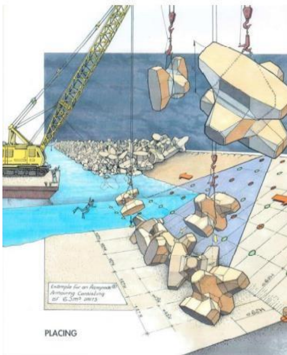
Dettaglio esecutivo della costruzione della mantellata.
