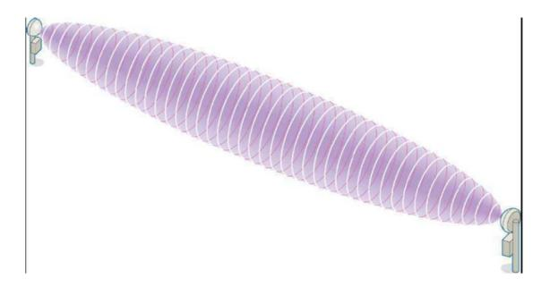
La barriera all'infrarosso attivo è composta da un'unità trasmittente ed una ricevente. Il trasmettitore emette una sequenza codificata di raggi infrarossi che vengono rilevati da tutti i ricevitori sviluppando un reticolo impenetrabile che genera un allarme quando viene interrotto a seguito di un attraversamento.
