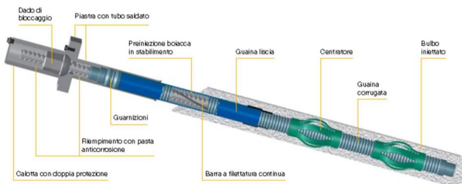
-Fig. 14 tipologia di intervento puntuale su singolo blocco
