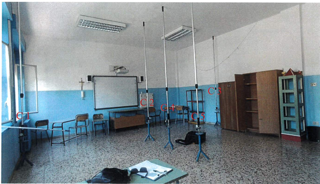
Fig. 1: Disposizione Comparatori Solaio
