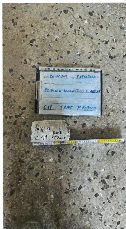
Fig. 22: Carbonatazione C11
