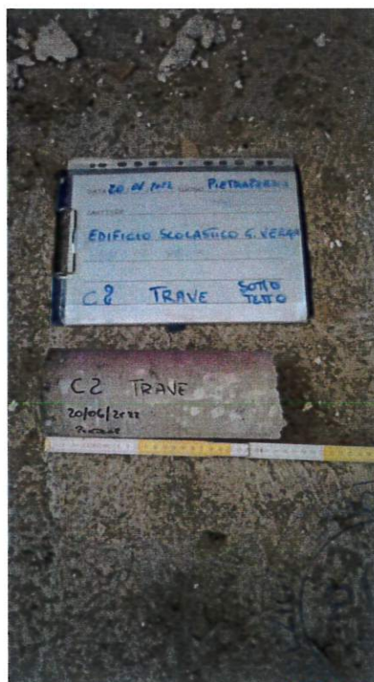
Fig. 4: Carbonatazione C2
