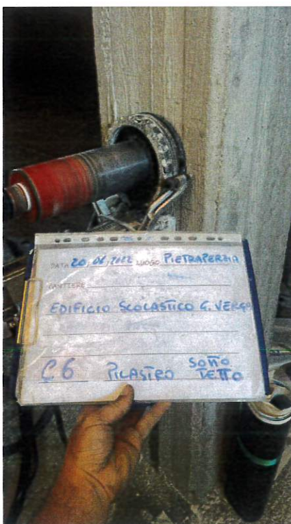
Fig. 11: Estrazione carota C6
