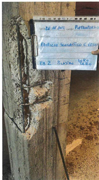
Fig. 50: Estrazione barra EB2
