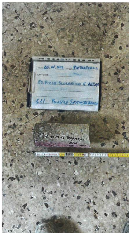
Fig. 42: Carbonatazione C21
