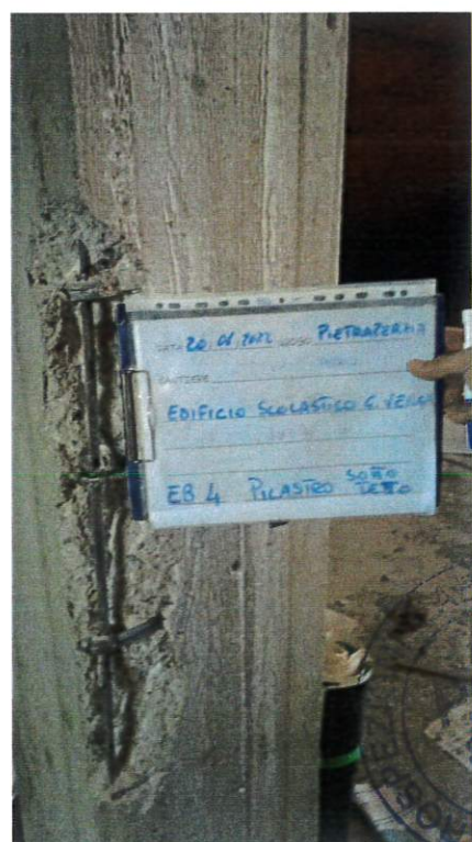
Fig. 52: Estrazione barra EB4
