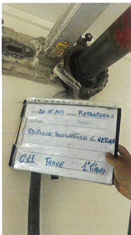
Fig. 21: Estrazione carota C11
