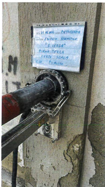
Fig. 39: Estrazione carota C20
