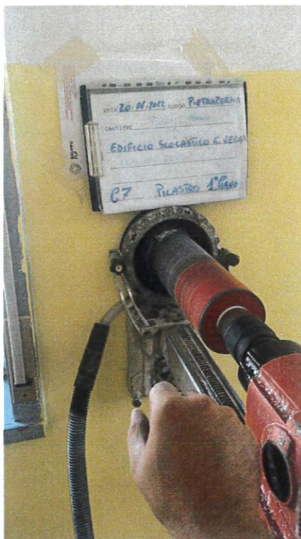
Fig. 13: Estrazione carota C7
