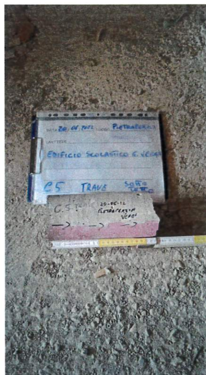
Fig. 10: Carbonatazione C5
