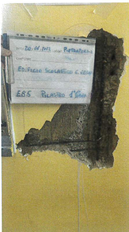
Fig. 53: Estrazione barra EB5
