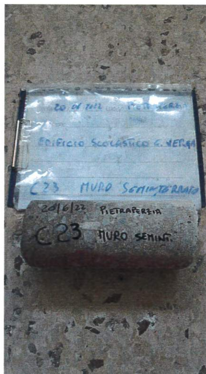
Fig. 46: Carbonatazione C23
