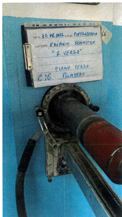
Fig. 31: Estrazione carota C16
