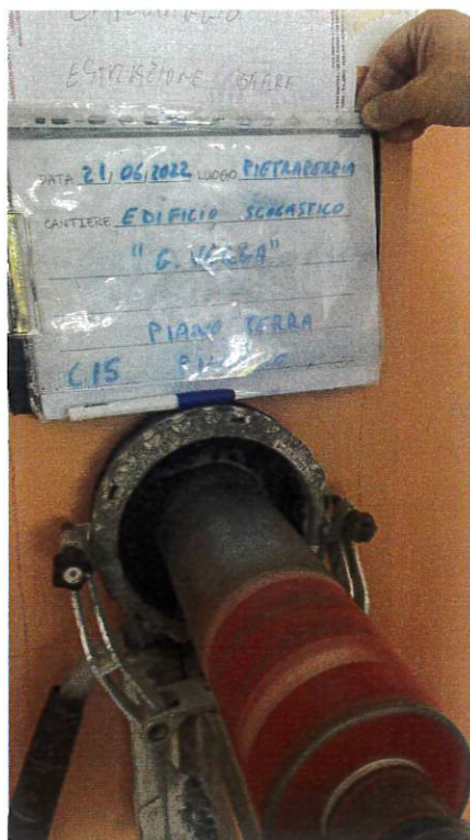
Fig. 29: Estrazione carota C15
