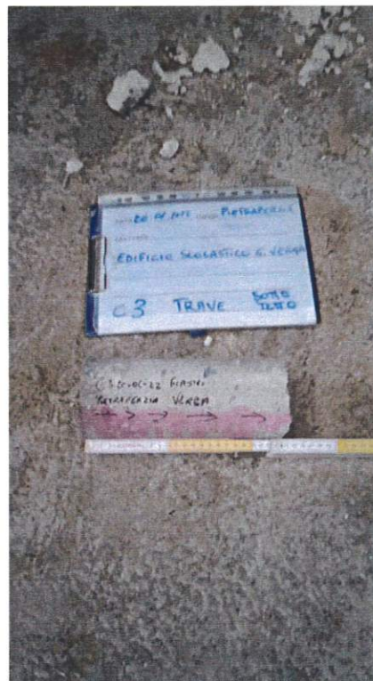
Fig. 6: Carbonatazione C3
