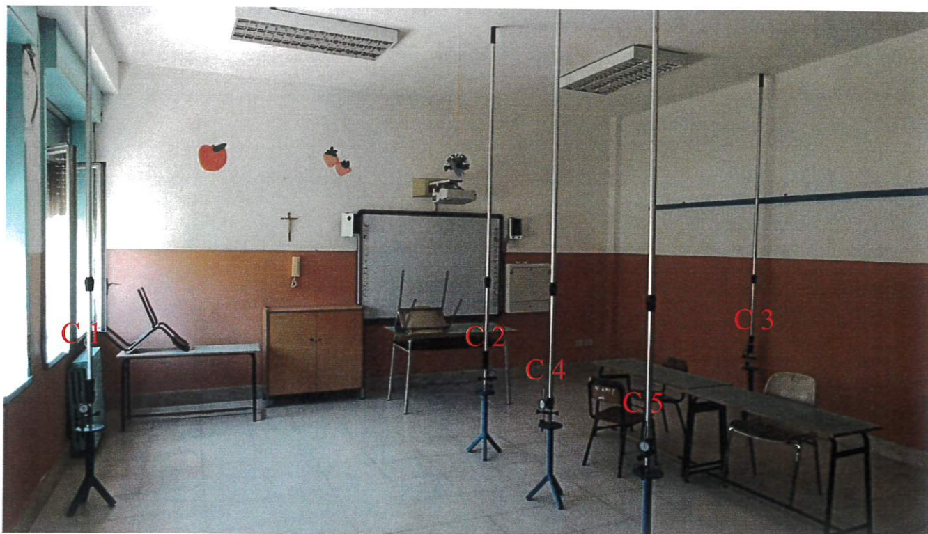
Fig. 3: Disposizione Comparatori Solaio
