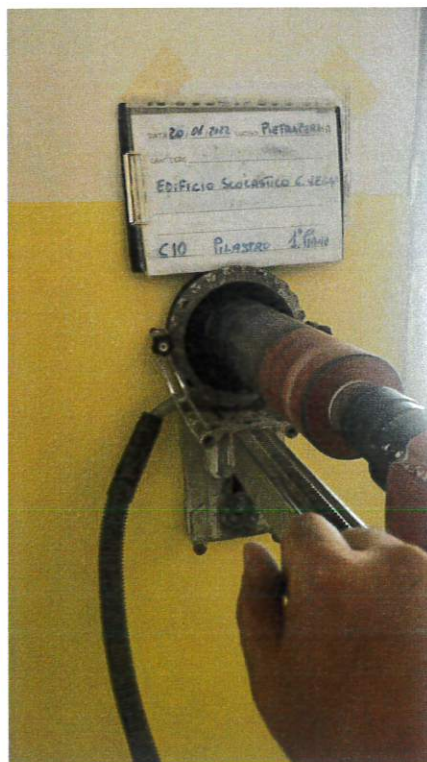
Fig. 19: Estrazione carota C10
