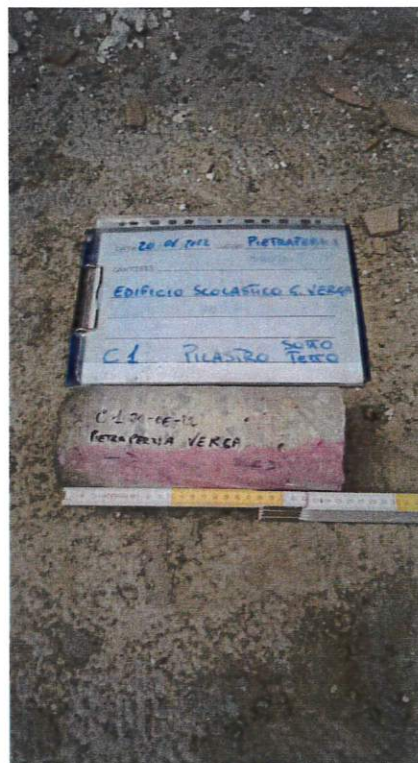
Fig. 2: Carbonatazione C1
