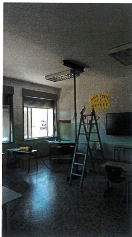
Fig. 4: Step di Carico (Solaio Sottoposto A Pieno Carico)
