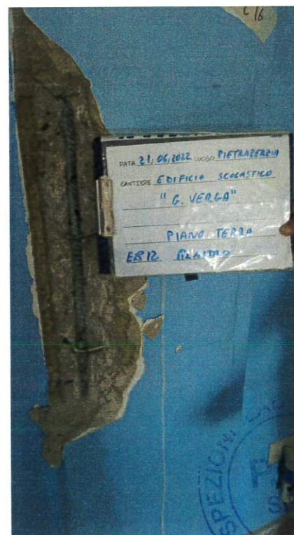
Fig. 60: Estrazione barra EB12
