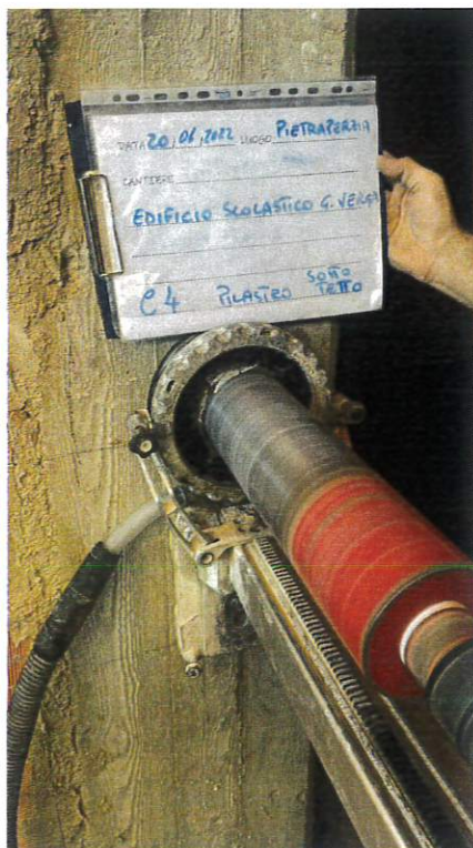
Fig. 7: Estrazione carota C4
