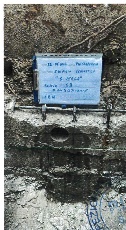
Fig. 64: Estrazione barra EB16
