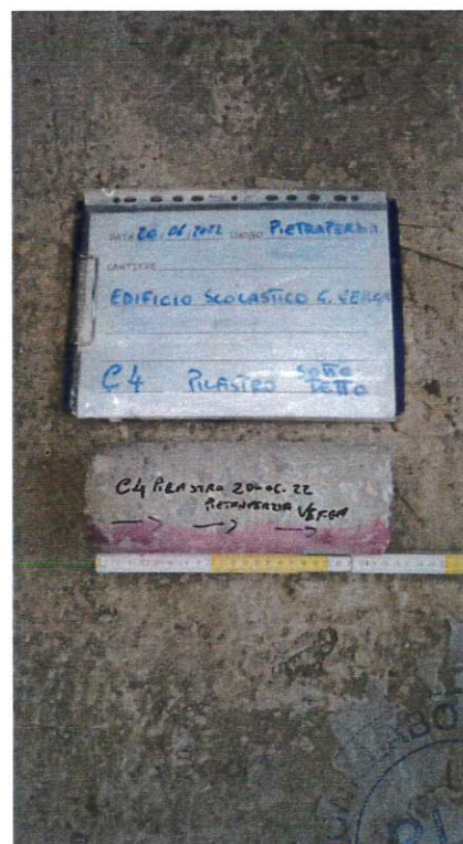
Fig. 8: Carbonatazione C4
