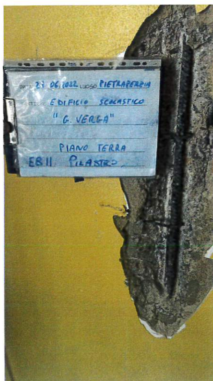
Fig. 59: Estrazione barra EB11
