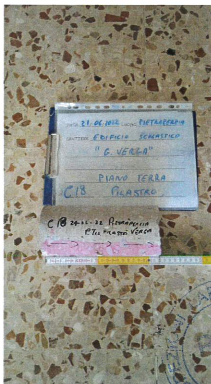
Fig. 36: Carbonatazione C18
