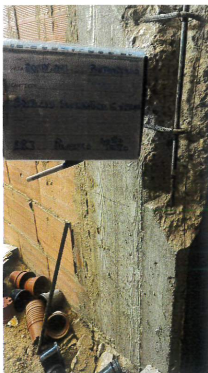
Fig. 51: Estrazione barra EB3
