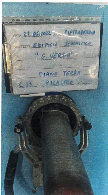
Fig. 25: Estrazione carota C13
