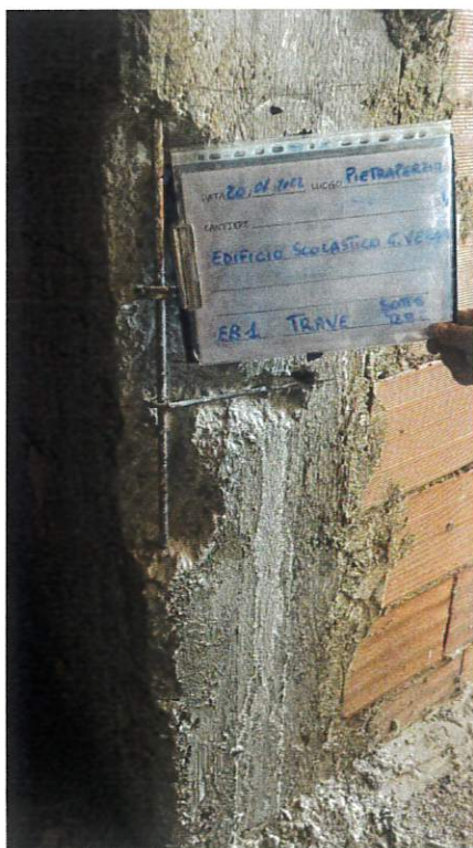
Fig. 49: Estrazione barra EB1
