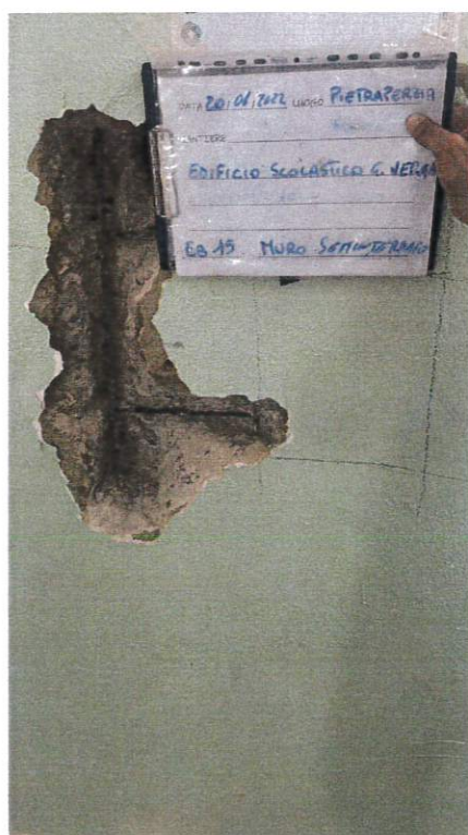
Fig. 63: Estrazione barra EB15
