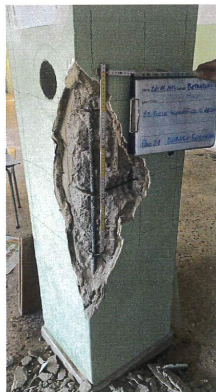
Fig. 62: Estrazione barra EB14
