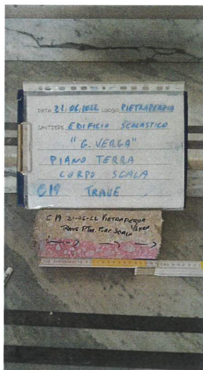
Fig. 38: Carbonatazione C19
