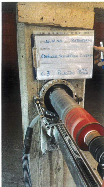
Fig. 5: Estrazione carota C3
