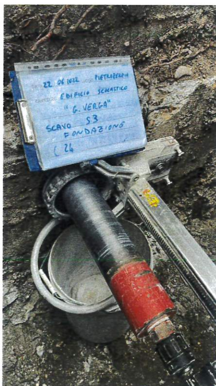
Fig. 47: Estrazione carota C24
