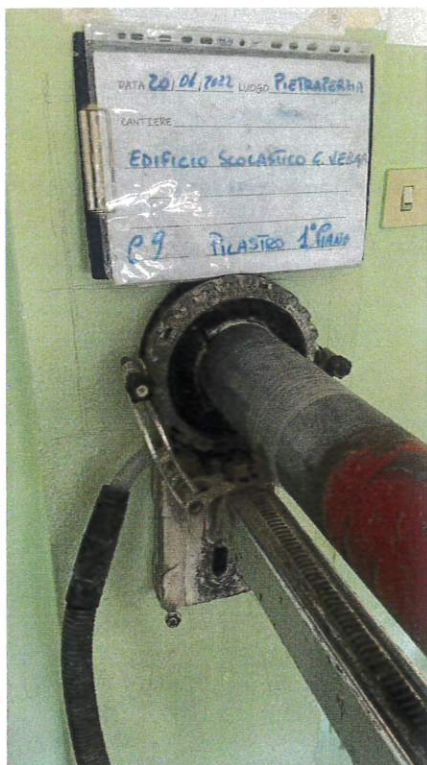
Fig. 17: Estrazione carota C9
