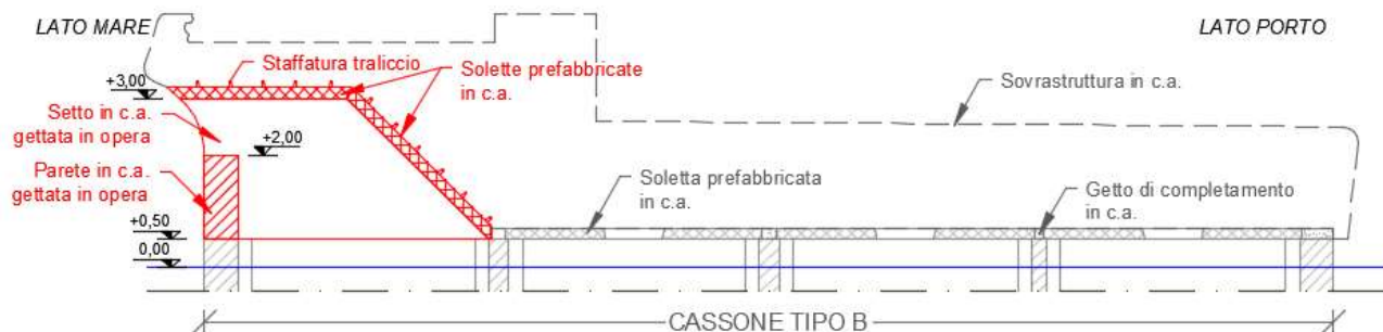
FASE 2: Elevazione delle pareti e dei setti in c.a. della prima fila di celle lato mare;
