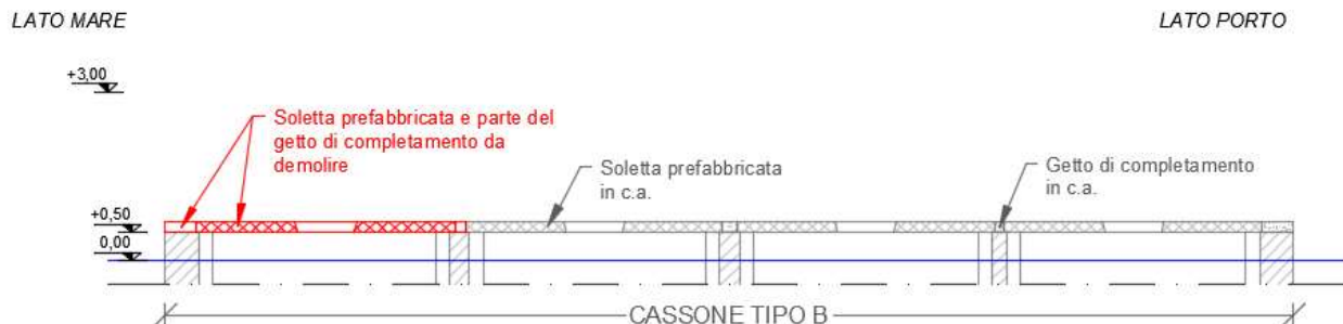
FASE 1: Demolizione delle solette prefabbricate in c.a. e parte del getto di completamento, in corrispondenza della prima fila di celle lato mare.
