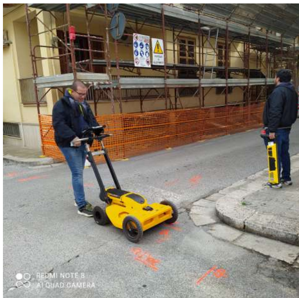
Foto N°1 – Rilievo georadar inizio di Via Manzoni
