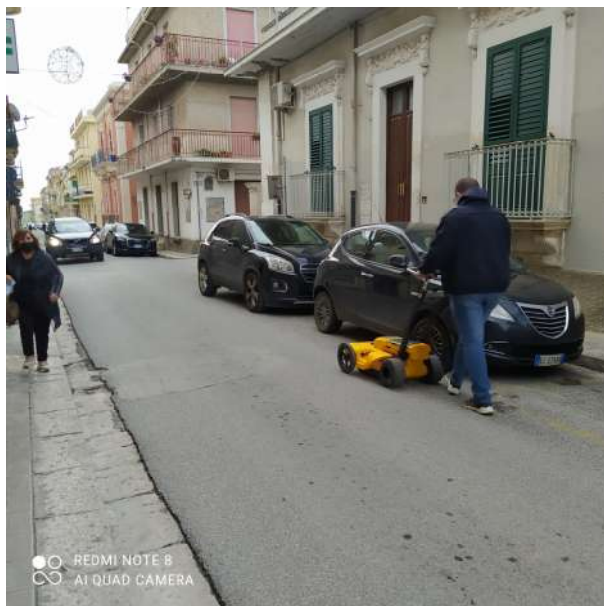
Foto N°2 – Rilievo georadar di Via Manzoni altezza Via Ducenzo
