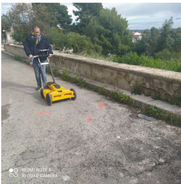
Foto N°12 – Rilievo georadar sottoservizi di Via L. Molino
