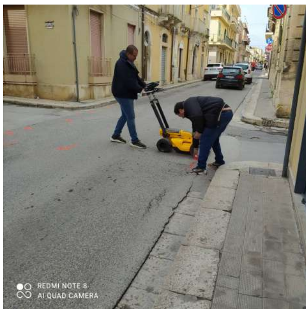
Foto N°4 – Rilievo georadar di Via Manzoni altezza Via Ferreni marcatura dei sottoservizi
