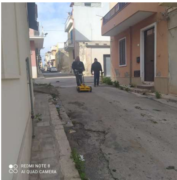
Foto N°10 – Rilievo georadar Via Monferrato
