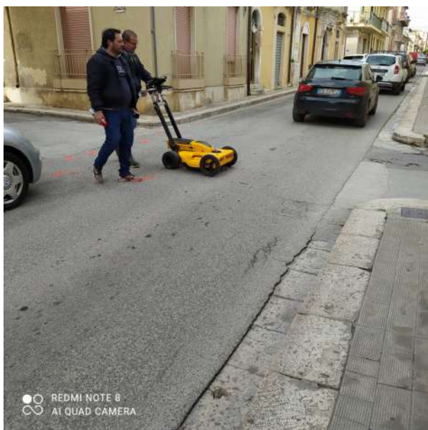
Foto N°3 – Rilievo georadar inizio di Via Manzoni
