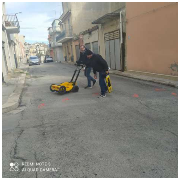
Foto N°9 – Rilievo georadar Via Arco Piccolo angolo Via Monferrato
