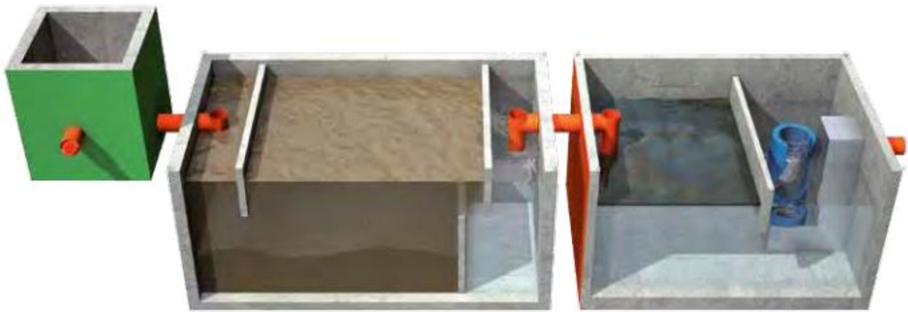
Figura 6 - Schema tipo vasca di prima pioggia (in continuo con by-pass)
