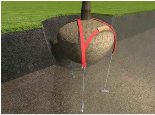
Buca per alberatura con sistema di ancoraggio con ancore metalliche
