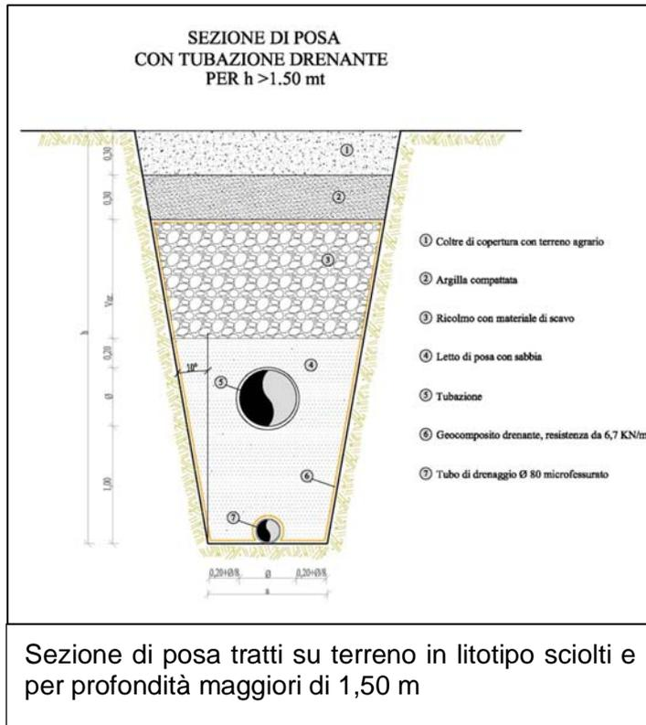
La sezione di scavo, per profondità superiori a 1,50 [m], sarà di tipo di tipo trapezoidale trapezoidale con pareti inclinate di  $10^\circ$  sulla verticale; il ricolmo, al di sopra dello strato di inglobamento della tubazione con materiale arido permeabile (sabbia), verrà realizzato con idonei materiali provenienti dagli scavi adeguatamente costipati.
